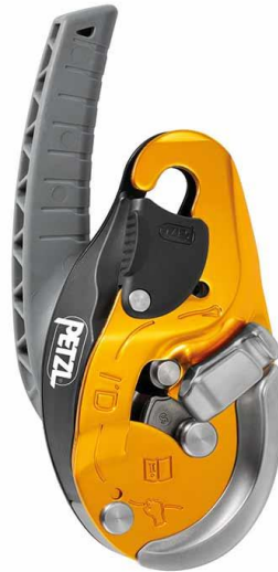
11. ábra Ereszkedőgép Petzl ID, tömege: 615 g, terhelhetősége: 250 kg. EN 341 típus 2 class A, CE EN 12841, Forrás: Petzl
