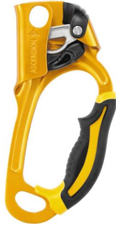
12. ábra Mászógép, Petzl Ascension (tömeg: 165 g, terhelhetőség: 165 kg), EN 12841, EN567 szabvány szerinti kialakítás, Forrás: PETZL
