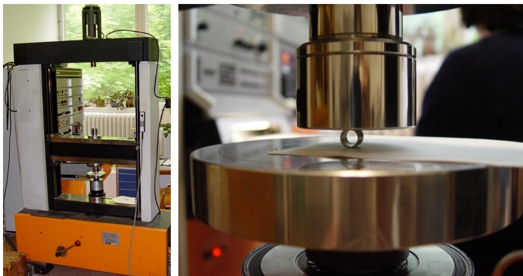
21. ábra. INSTRON 1195 típusú univerzális szakítógép és egy Zr gyűrű roppantása
