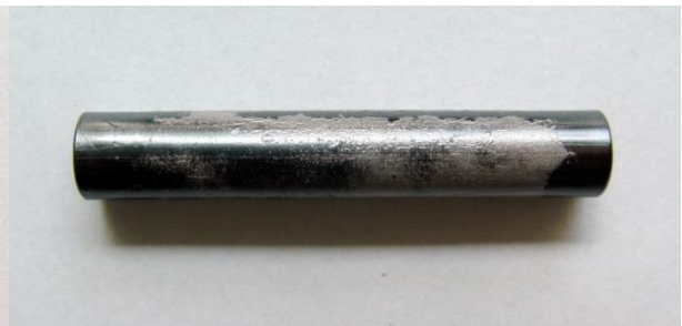
68. ábra. 1100 °C-on oxidált EO-11 jelű minta fényképe (ECR=2,1%)
