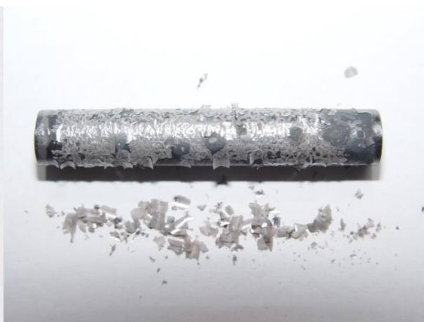
64. ábra. 1000 °C-on oxidált EO-03 jelű minta fényképe (ECR=1,6%)
