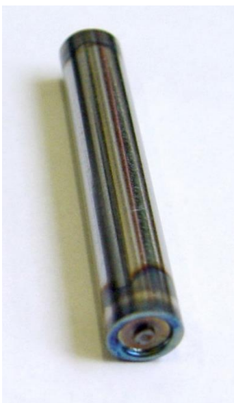
11. ábra. Az E110 mintadarab műszaki rajza és egy az oxidáció előtti, lehegesztett minta fotója
