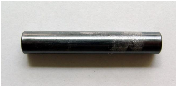
67. ábra. 1100 °C-on oxidált EO-09 jelű minta fényképe (ECR=1,3%)
