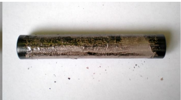
70. ábra. 1100 °C-on oxidált EO-10 jelű minta fényképe (ECR=4,2%)
