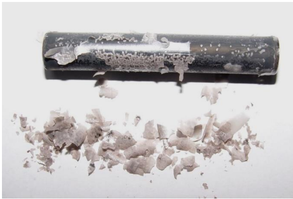
65. ábra. 1000 °C-on oxidált EO-04 jelű minta fényképe (ECR=2,5%)
