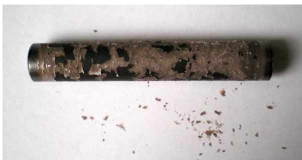
62. ábra. 900 °C-on oxidált EO-06 jelű minta fényképe (ECR=4,0%)
