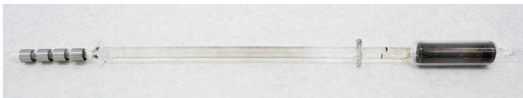
30. ábra Gyűrűminták a lágyvas maggal ellátott kvarcüveg mintatartón
