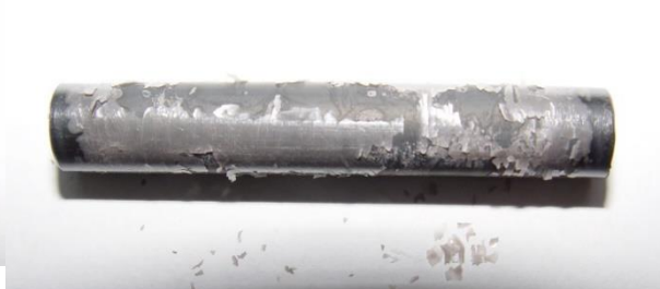
61. ábra. 900 °C-on oxidált EO-07 jelű minta fényképe (ECR=1,5%)
