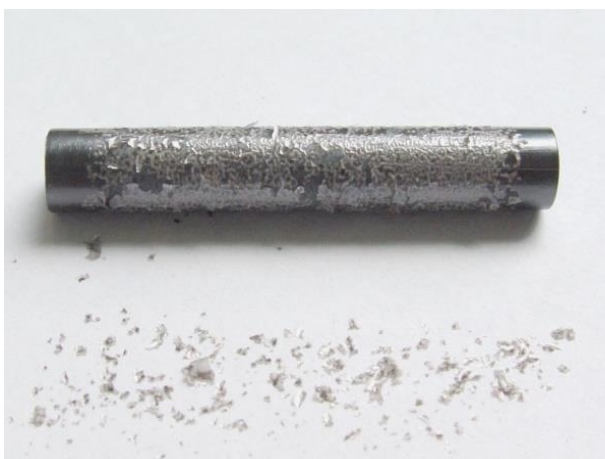
63. ábra. 1000 °C-on oxidált EO-01 jelű minta fényképe (ECR=1,1%)
