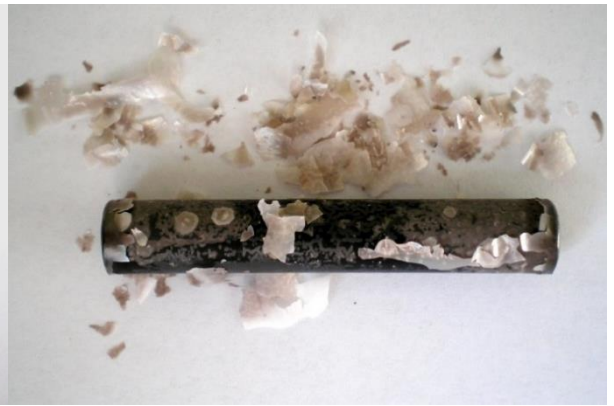
66. ábra. 1000 °C-on oxidált EO-02 jelű minta fényképe (ECR=4,8%)
