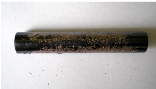
69. ábra. 1100 °C-on oxidált EO-08 jelű minta fényképe (ECR=4,0%)
