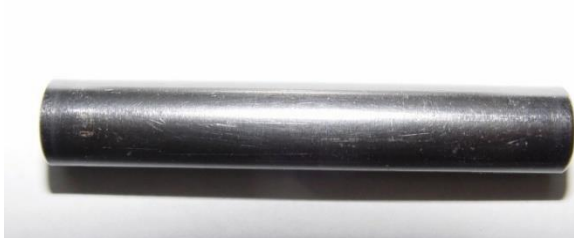
60. ábra. 900 °C-on oxidált EO-05 jelű minta fényképe (ECR=1,0%)
