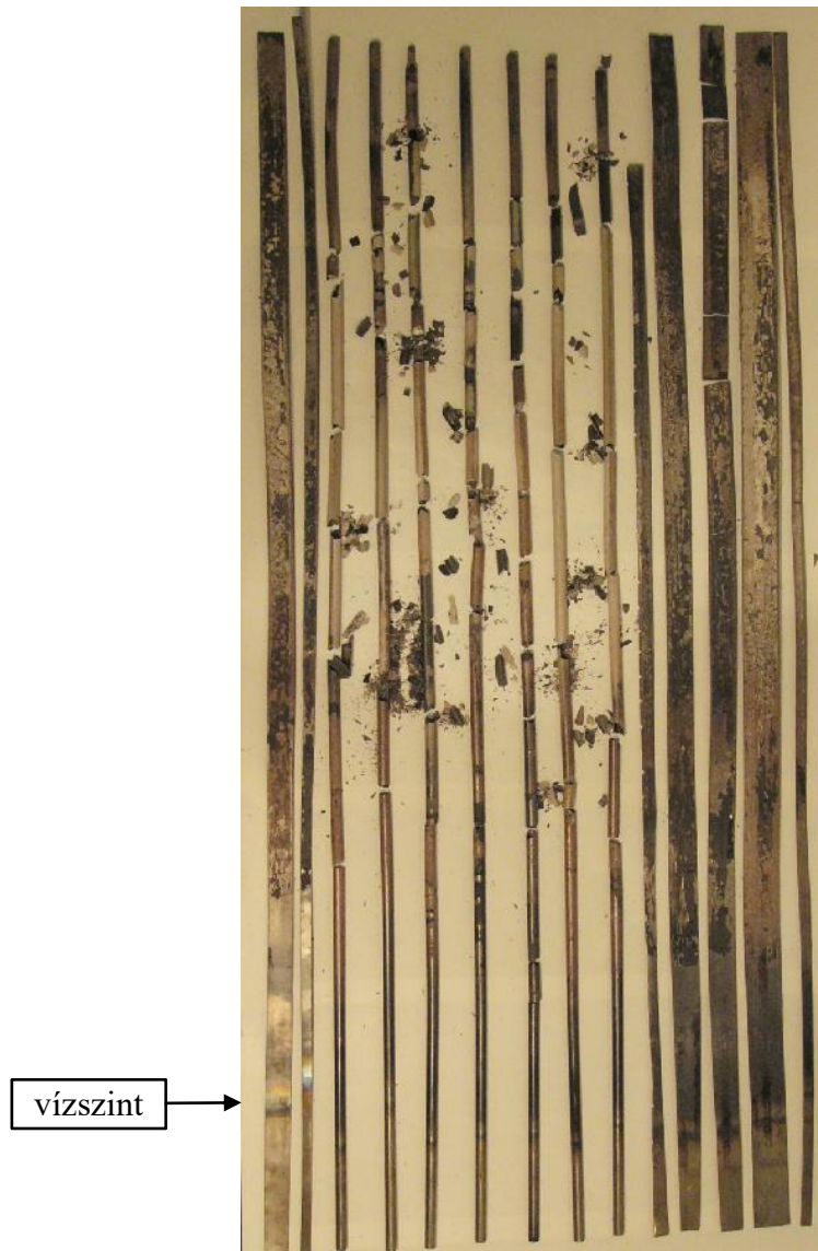
80. ábra. Az előkísérletben megsérült csövek és kazettafal lemezek eredeti pozíciójukban
