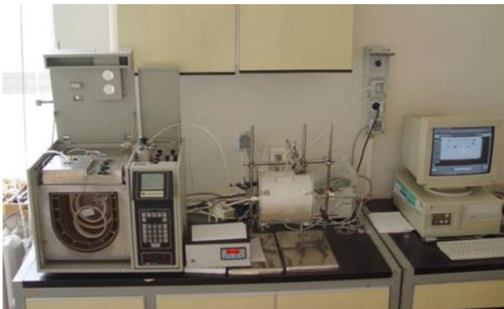
19. ábra. A hidrogéntartalom meghatározásához használt berendezés fényképe (balról jobbra: gázkromatográf, mikroprocesszoros hőmérsékletszabályozó, csökemence, adatgyűjtő PC)
