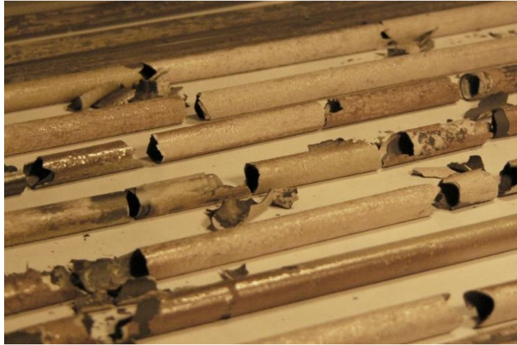
79. ábra. Az előkísérletben sérült cirkónium csövek
