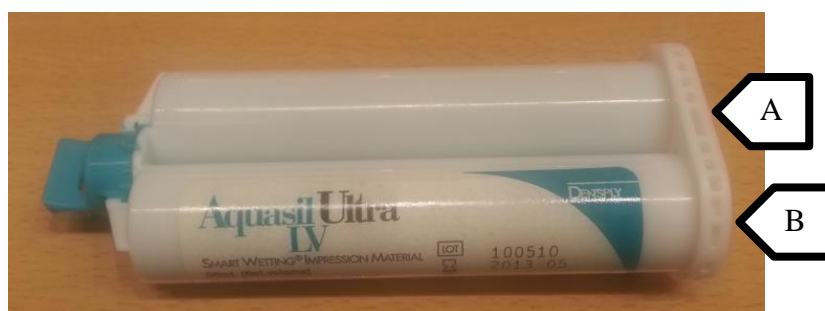
38. ábra: Az ujjnyomat másolására alkalmas plasztikus anyag
