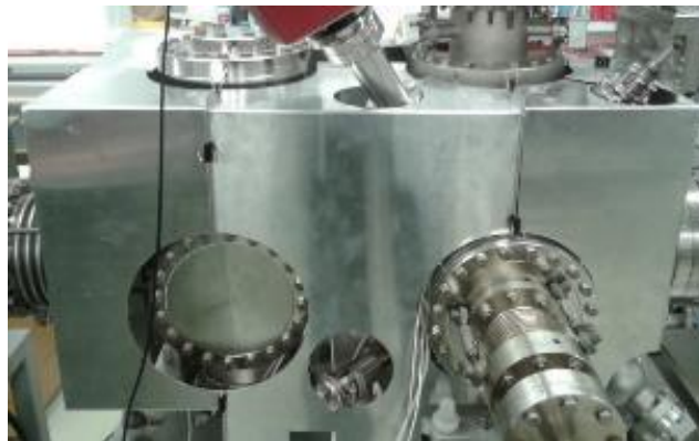
47. ábra. Az MBE rendszerünk főkamrája, bedobozolva.
