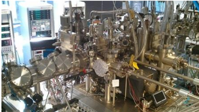
30. ábra. Egy Drezdában működő laboratórium III-V alapú molekulásugár epitaxiás berendezése 5 .
