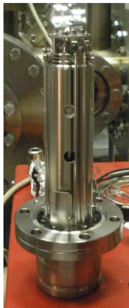
56. ábra. Az MBE rendszerünkben alkalmazott kvadrupól tömegspektrométer (QMS) mérőegysége.
