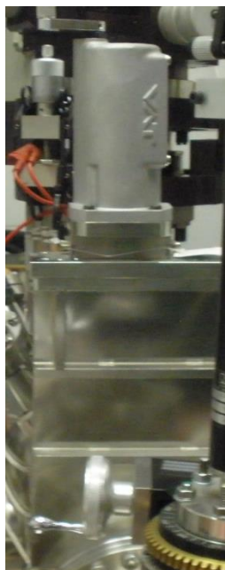
50. ábra. Az MBE rendszerünk vákuumszelepe, a zsillipkamra és a főkamra között.
