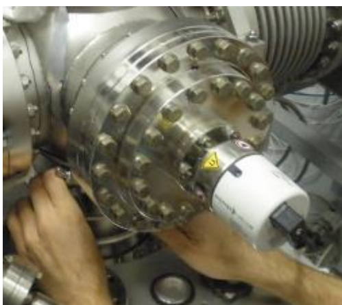
51. ábra. A főkamrán elhelyezett hidegkatódos vákuummérő.
