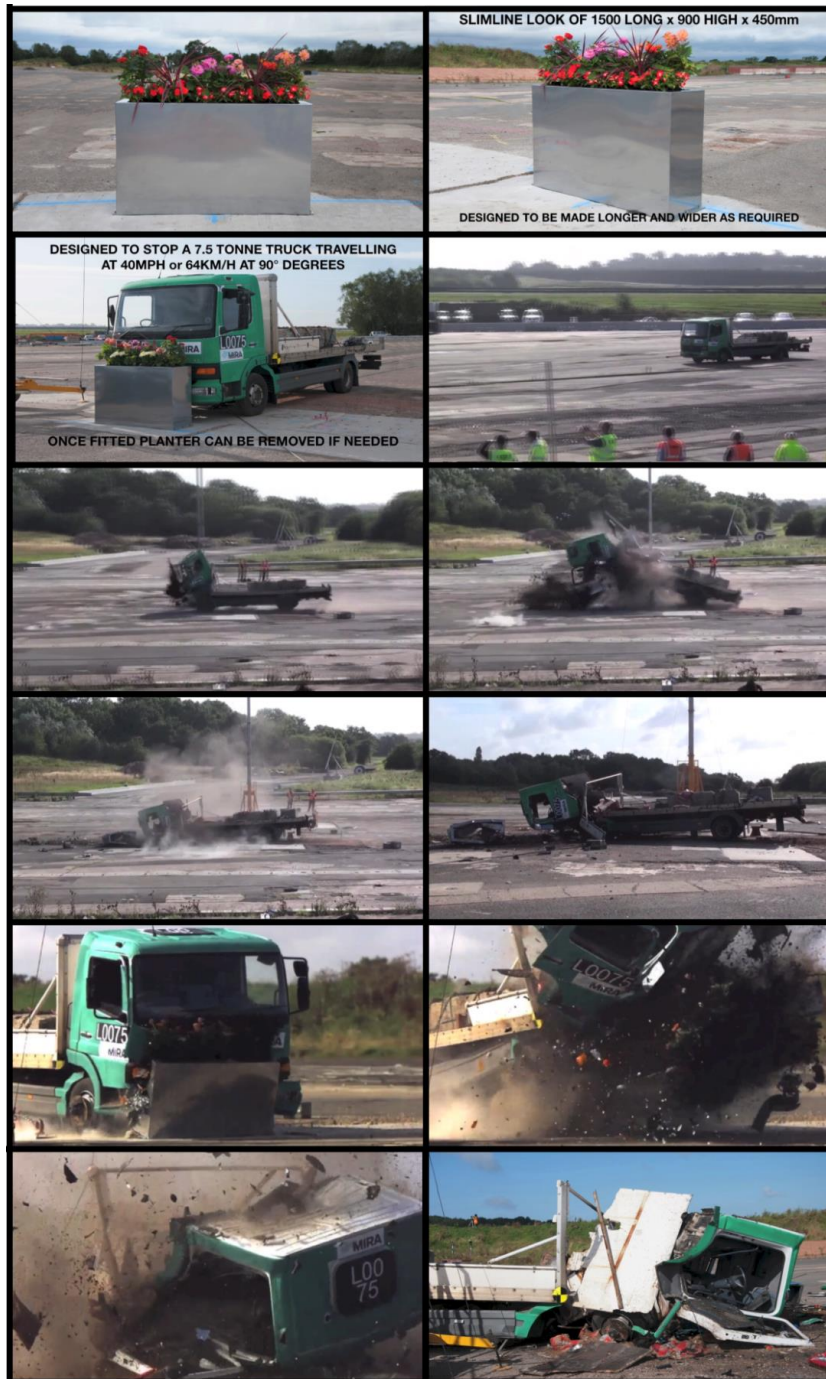
144. Képek: 100kg-os felületszerelt járműakadály tesztelése 7,5 tonnás, 64 km/h sebességgel haladó jármű, 90°-os becsapódási szög esetén [147] 305
