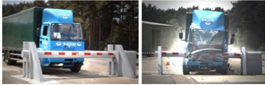
50. Képek: Sorompó tesztelése őrzött állapotban 131
