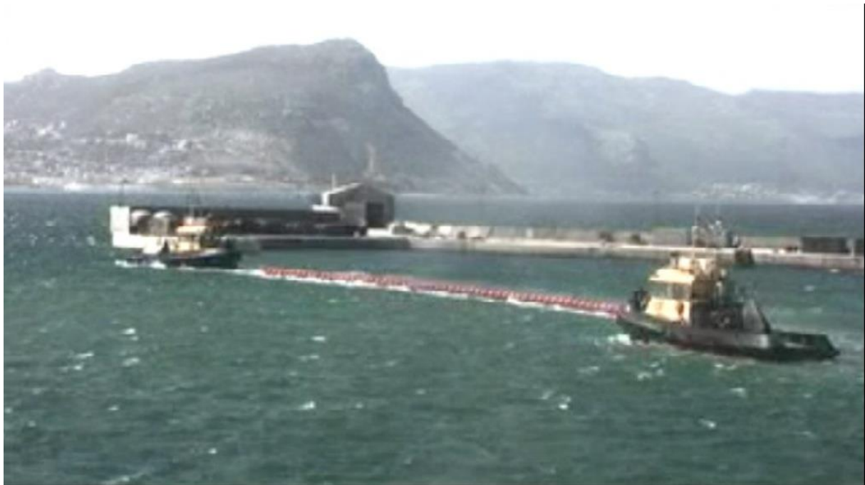
143. Kép: Vízi járműakadály telepítése [146] 304
