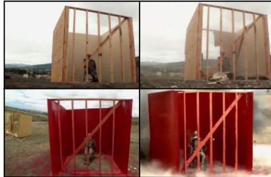
24. Képek: Line-X-el kezelt és kezeletlen fászerkezet tesztelése 91
