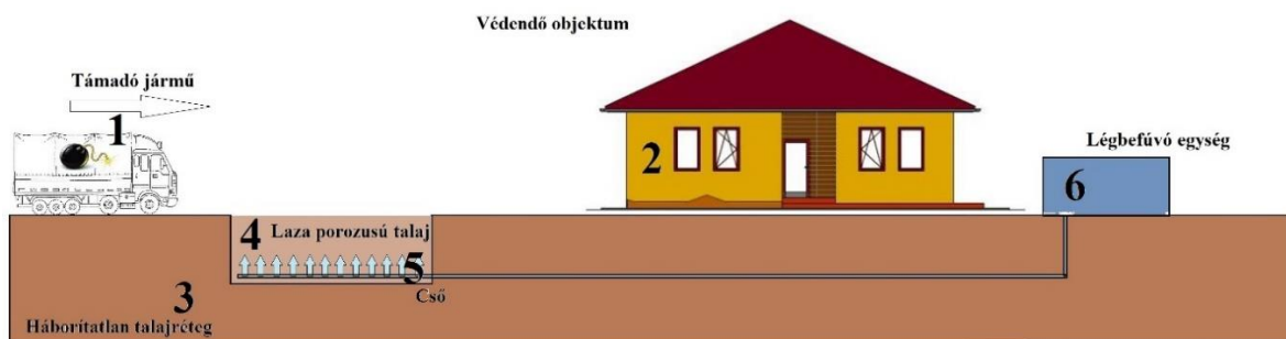
51. Ábra: Futóhomok rendszer felépítése 132
