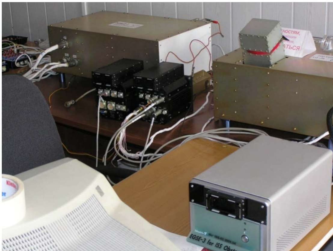
23. ábra. Az EGSE használata Moszkvában bemérés közben. A képen a háttérben látható két konténerbe kerülnek a tudományos műszerek
