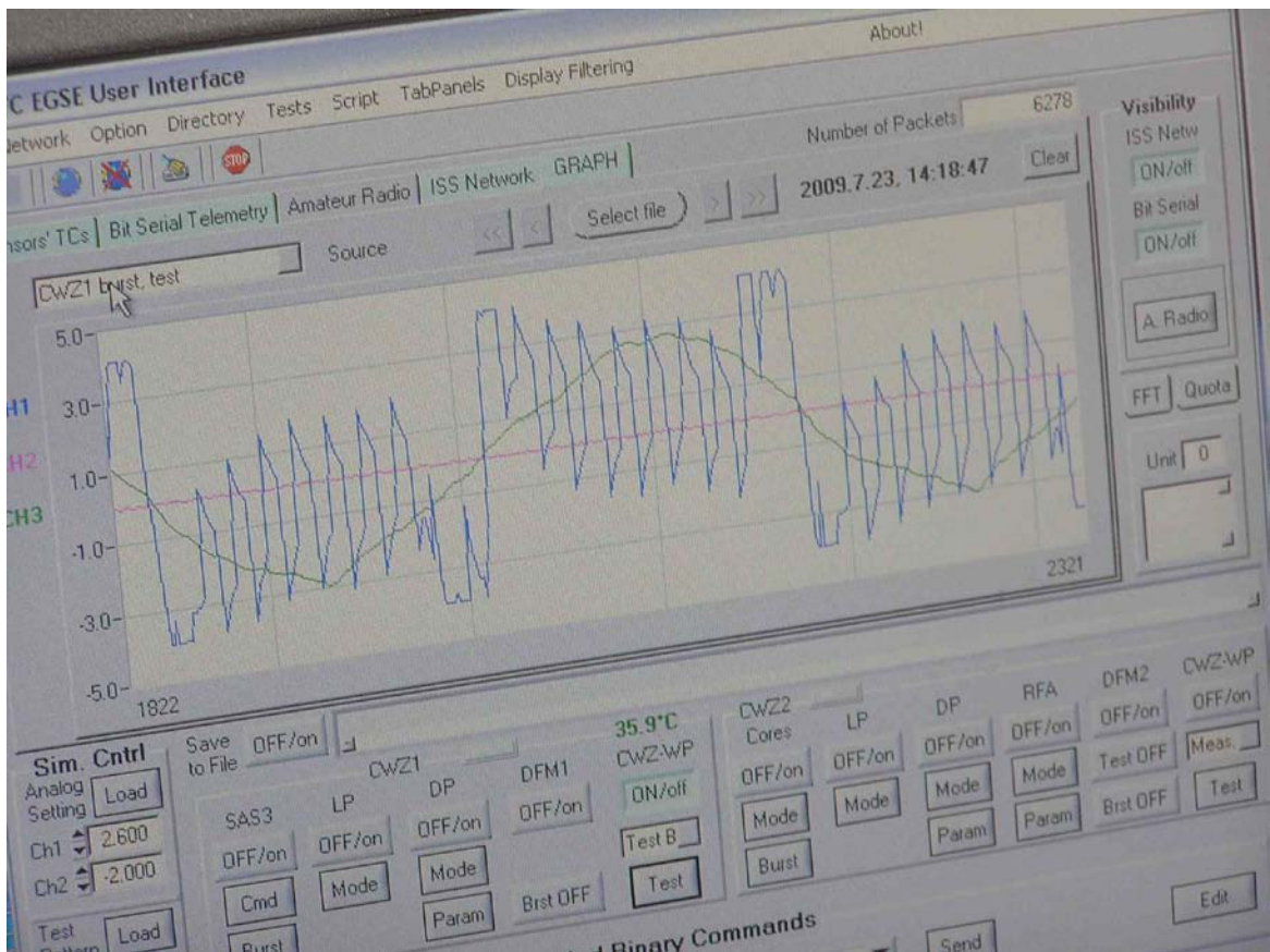
4. ábra. Az EGSE-re fejlesztett tesztprogrammal a CWZ-1 vizsgálata burst üzemmódban.
