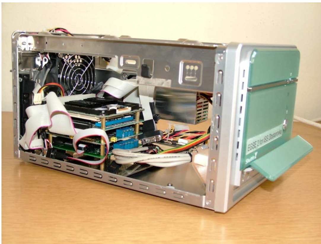
22. ábra. Az EGSE beágyazott processzoros részegysége szerelés közben
