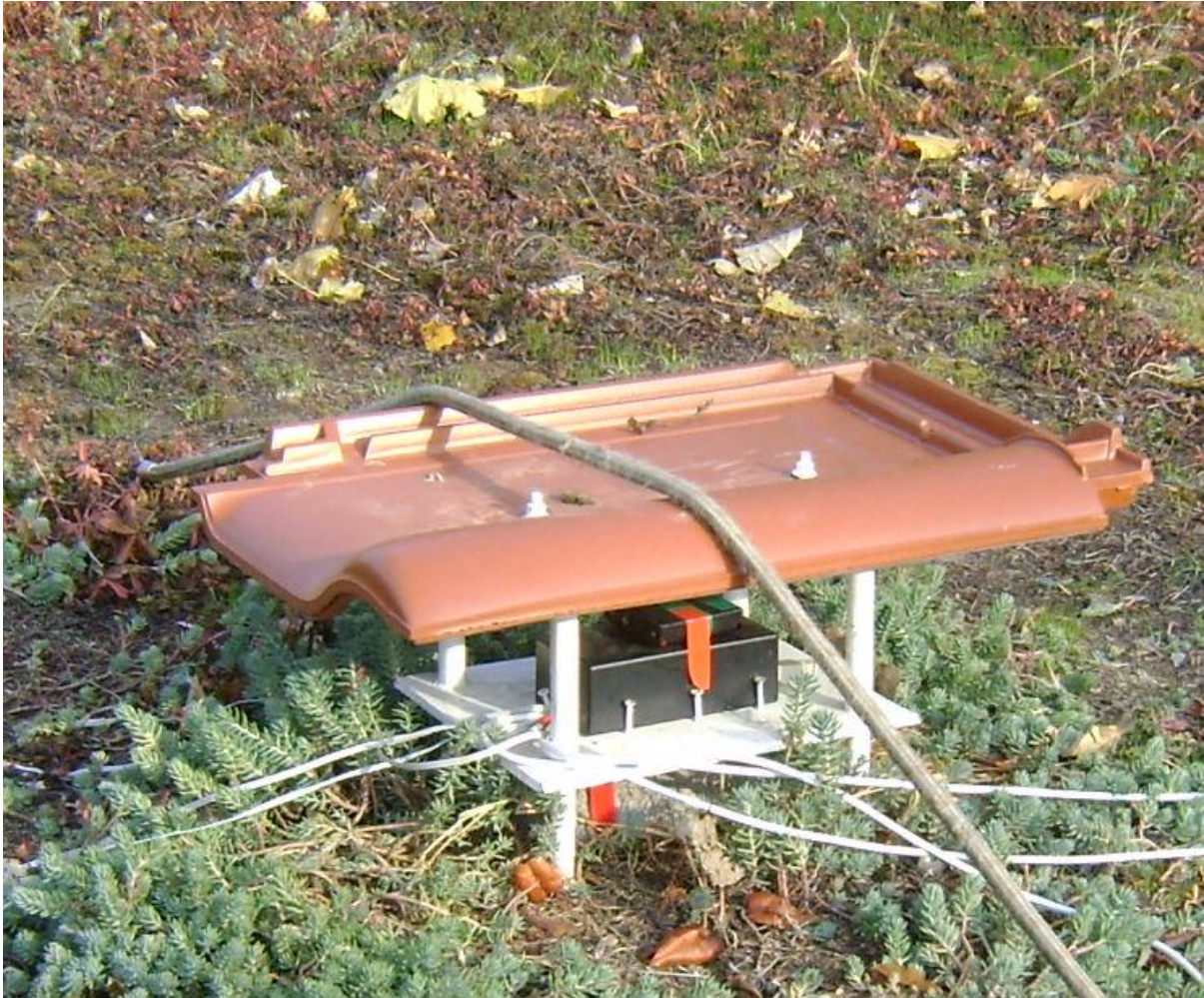
4.6. ábra A védelmet ellátó egység az elektromos vezérlő egységgel, az elektromos teleppel és a mérőkábelekkel
