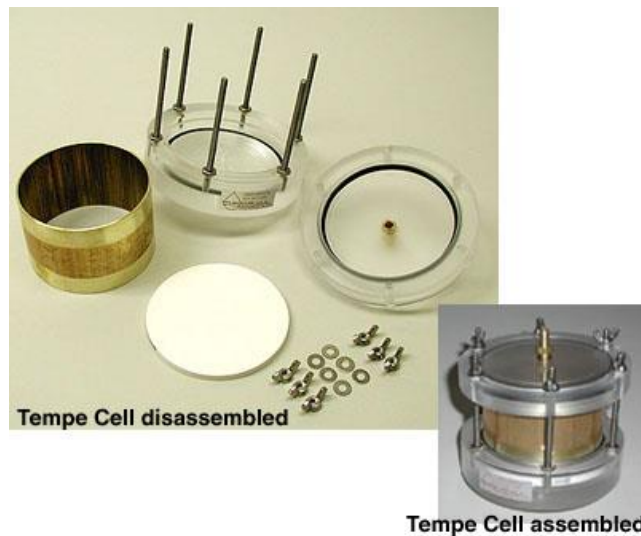
3.18. ábra Tempe cella szétszedett (felső kép) és összerakott (alsó kép) állapotban
