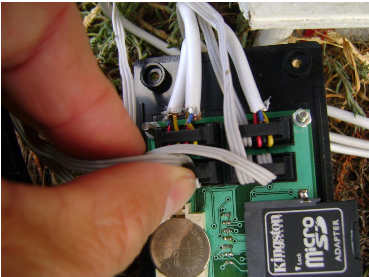
4.7. ábra A PIC18F4550 típusú microcontroller vezérlő egység a csatlakozó mérővezetékekkel, az adattároló SD kártyával és CR2032 egyenáramú áramforrás az órához
