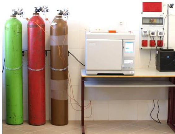
30. ábra A mérésekhez használt gázkromatográfiás berendezés (Forrás: saját kép)
