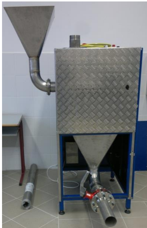
23. ábra Shark nyírótechnológiával működő vizes aprító berendezés (Forrás: saját kép)
