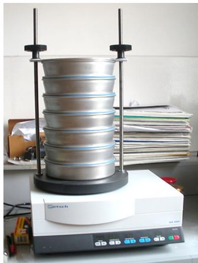
33. ábra Reutch rázógép a szitasorral (Forrás: saját kép)
