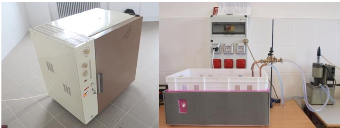
31. ábra Az inkubátor szekrény és az inkubálást biztosító vizes kád (Forrás: saját kép)
