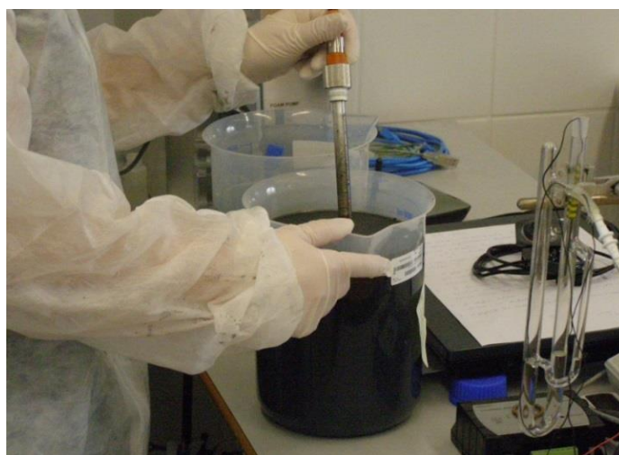
36. ábra A fermentlé pH mérése (Forrás: saját kép)
