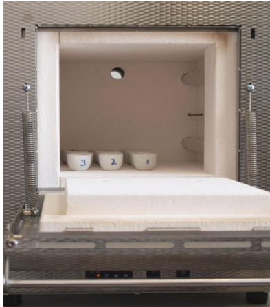
27. ábra Nabatherm CE 4/11/R6 típusú kemence és a sorszámozott kerámia edények (Forrás: saját kép)
