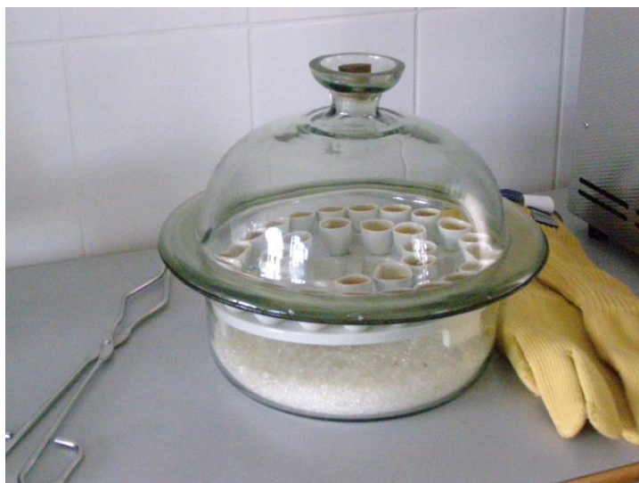
29. ábra Az exszikkátor (Forrás: saját kép)
